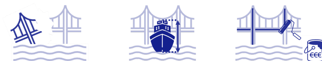
Figuur 5.1: Onderscheid tussen einde technische, functionele en economische levensduur aan de hand van een voorbeeldbrug, waar bijvoorbeeld de constructieve integriteit, het niet kunnen voldoen aan eisen van de scheepvaart en/of hoge onderhoudskosten er voor kunnen zorgen dat einde levensduur bereikt wordt (KpNK, 2024d).
