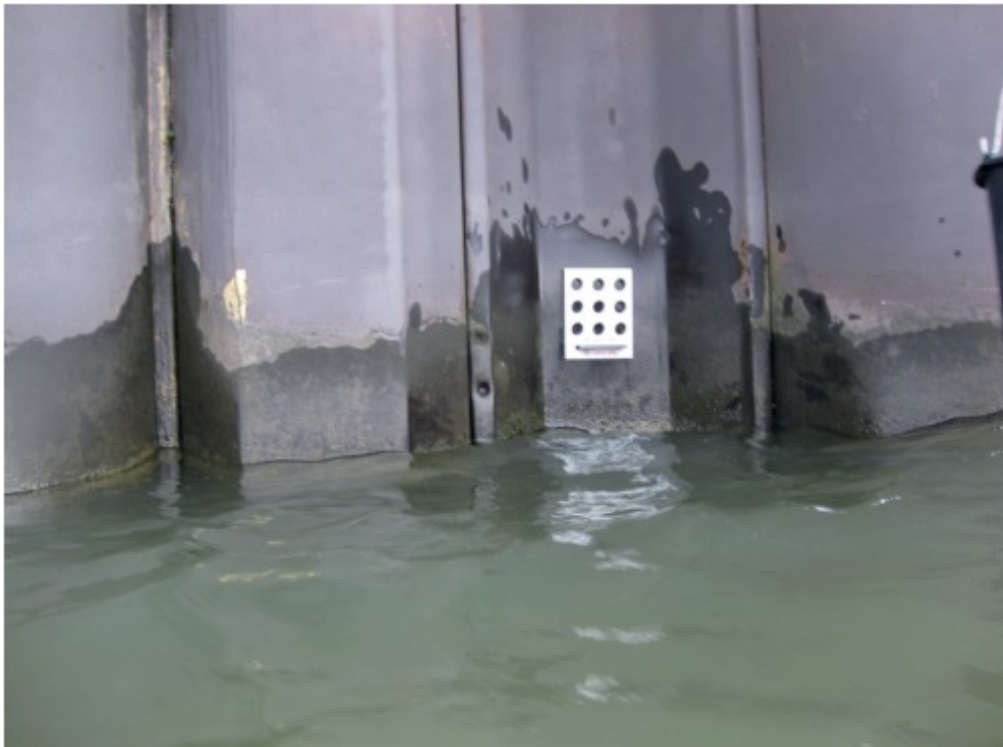
Figuur 3.10 Een meetmal voor negen ultrasone metingen [CURSBRnet 2017]
