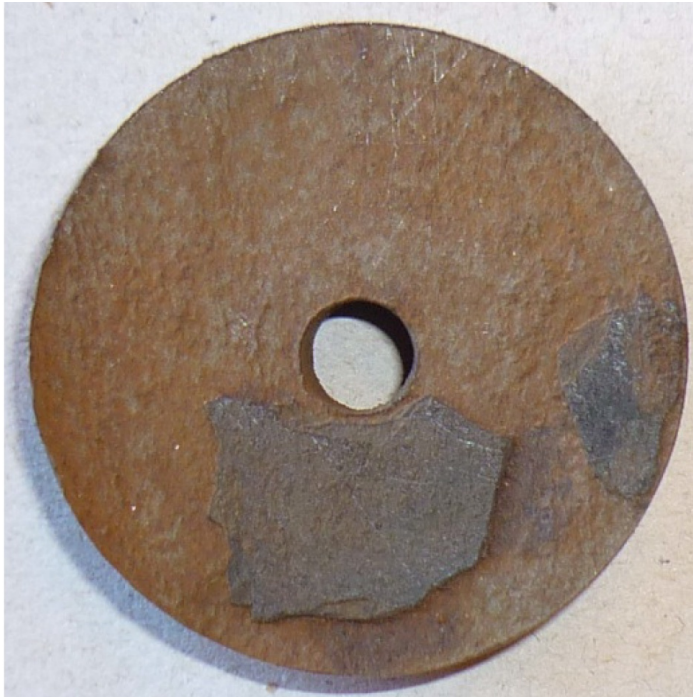
Figuur 2.34 Achterzijde van monster van de voorflens van de Hoesch Iv uit Gouda waarop de oorspronkelijke coating nog aanwezig was [Acotec 2012b]
