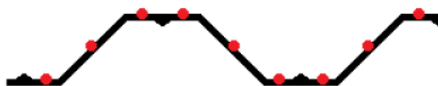
Figuur 2.33 Meetpunten (rood) op een damwand bestaande uit een Hoesch-profiel [Acotec 2012b]
