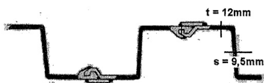
Figuur 2.6 Schematische weergave van damwandprofiel bij sluis Eefde [Acotec 2012a]
